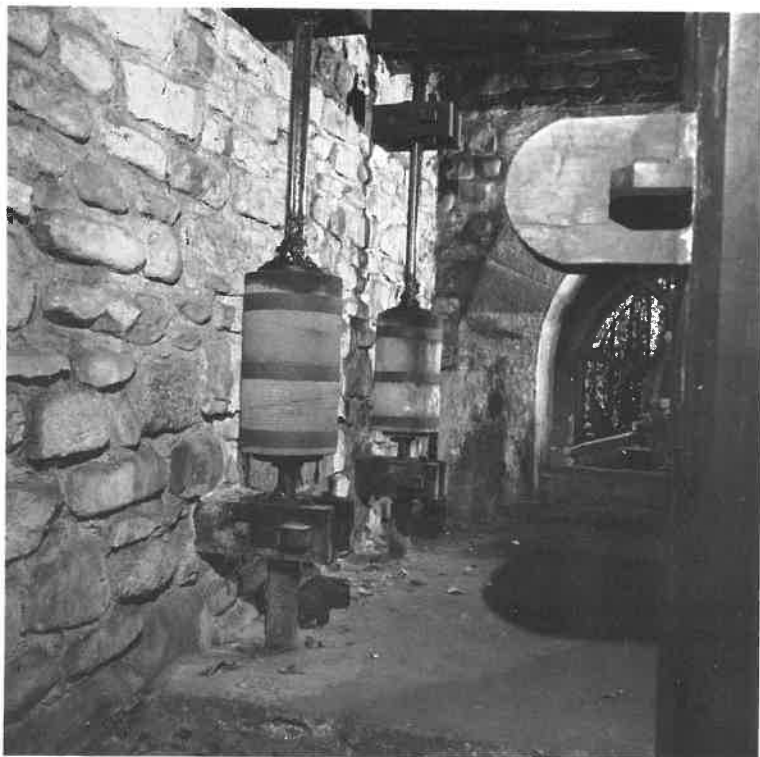
Contrapeso. Una vez que el esgamel queda libre del diente, vuelve a su posición primitiva por la acción del contrapeso.
