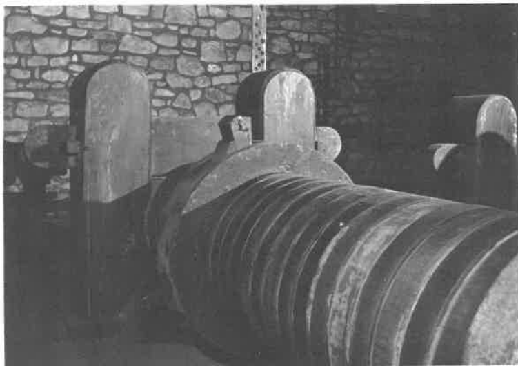
“Gabiardatza”, con los “masukariak”. El eje, construido con madera, podía durar más de 50 años en servicio.
