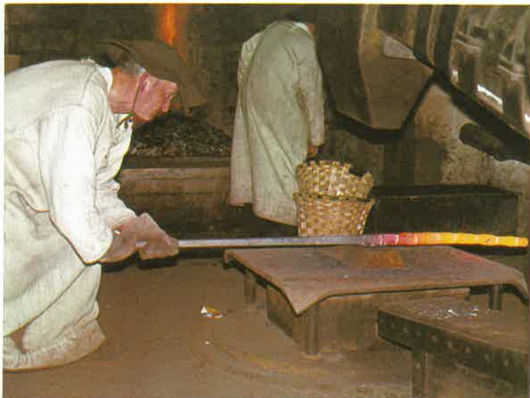
Operación de forja. En las ferrerías menores se reducía el hierro a barras largas.
